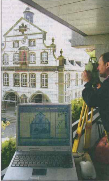
Die Briloner Rathausfassade wird mit „TachyCad“ vom Dach der Sparkasse elektronisch abgetastet.
